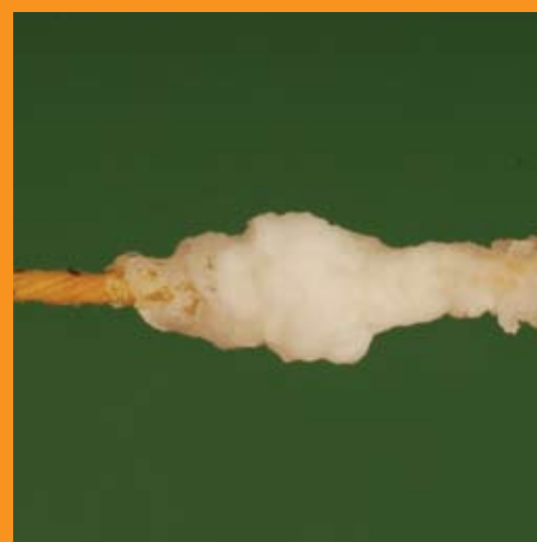
Formación sólida de carbonato de sodio en el hilo.
