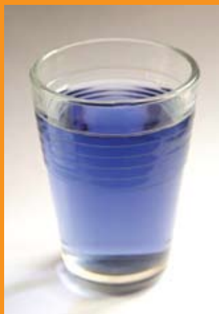
Solución indicadora de pH preparada con repollo colorado.
